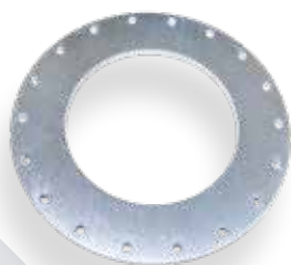
Flanschring Laserteil mit starker Kantenverrundung aus 6 mm 1.4301
