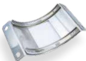
Krallenschelle Rollbiede-/Punktschweißteil aus 2 mm 1.4571
